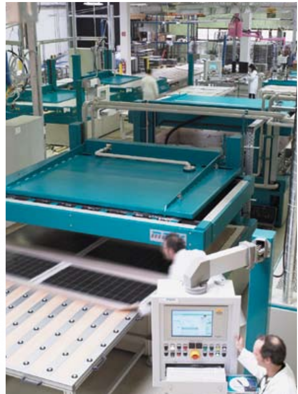
Solar-factory에서의 태양광 전지모듈 생산
